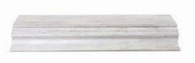
Багет №8 Высота багета 54 мм | Макс. длина багета 2400 мм Выпуклый: r 300 мм, h 54 мм, 350x350 мм | Вогнутый: r 280 мм, h 54 мм, 350x350 мм
